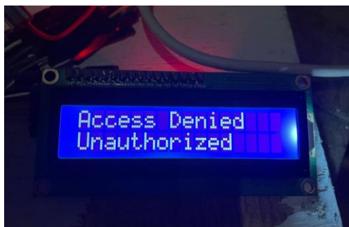
Gambar 12. Layar LCD saat kartu belum terdaftar
