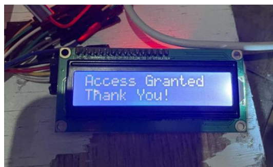
Gambar 11. Layar LCD saat kartu berhasil didaftarkan
