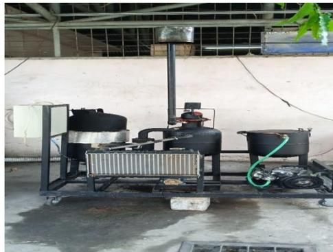
Gambar 2.1 Alat Gasifikasi Sistem *Crossdraft Gasifier*.
