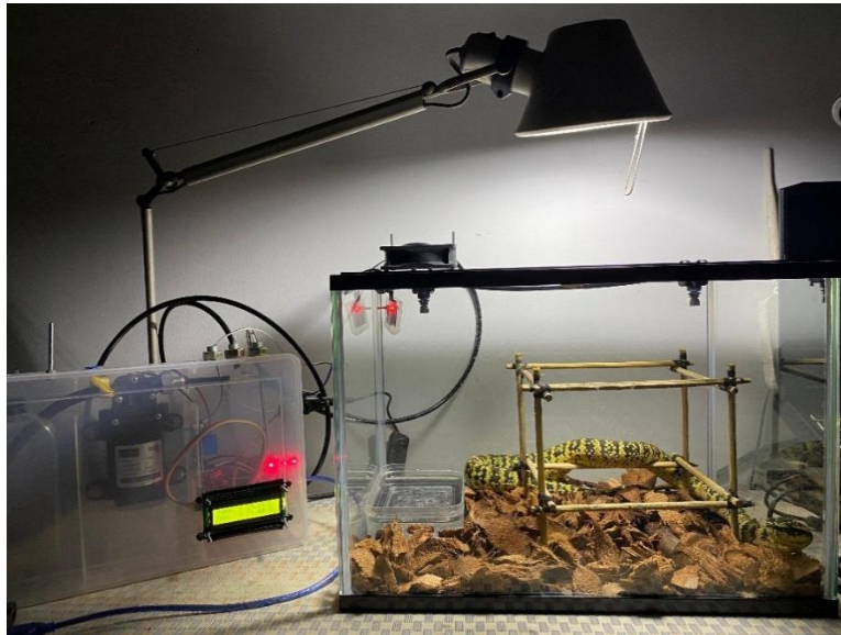
Gambar 8. Implementasi sistem kontrol kelembapan otomatis di terrarium Tropidoleamus sp.
